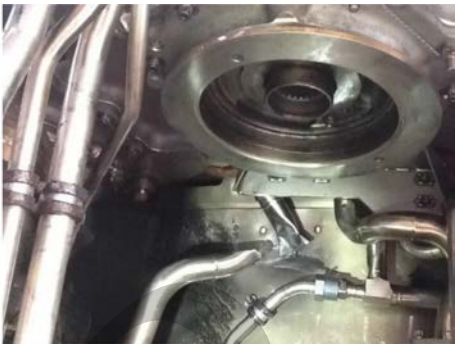
图 1 空客 A330 ATS200 空气涡轮起动机非包容性事故
