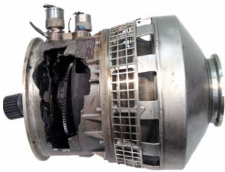
图 1 空客 A330 ATS200 空气涡轮起动机非包容性事故
